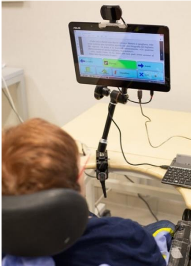
pav. 6 Aukštųjų technologijų AT: Komunikatorius su kalbos atpažinimu ir galvos sekimu (Nuotraukos: Fondazione Santa Lucia)
