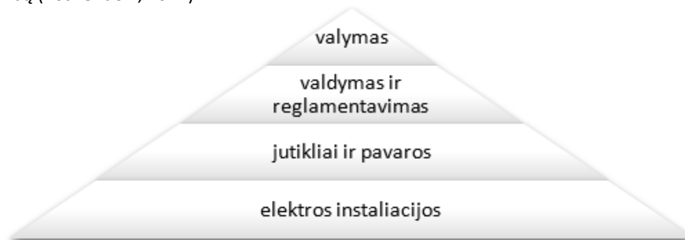
pav. 14 Skirtingi pastatų automatizavimo lygiai (remiantis Wisser, 2018 m.)
