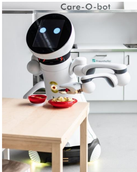
pav. 29 Care-O-Bot 4 gali atpažinti maistą lėkštėje, paimti jį šaukštu ir pateikti prieš žmogaus burną (Paveikslėlis: R. Bez © Fraunhofer IPA)
