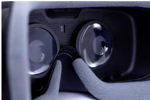
pav. 52 sugeriantis putplasčio paminkštinimas VR akinuose
