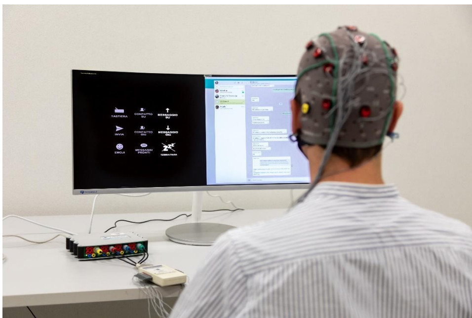
pav. 75 P300 pagrindu veikiančios BCI sąrankos pavyzdys
