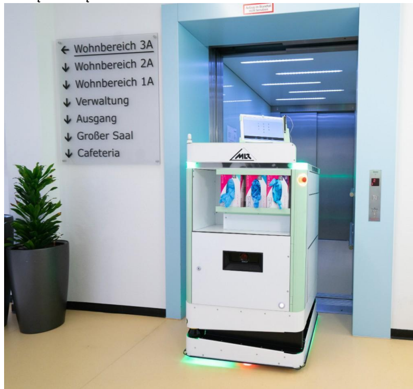
pav. 23 Išmanusis priežiūros vežimėlis savarankiškai važiuoja į tikslą (Paveikslėlis: R. Bez © Fraunhofer IPA)
