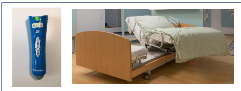
Εικόνα 5: Μεσαίας τεχνολογίας ΑΤ: Στυλό που διαβάζει λέξεις που έχουν αποθηκευτεί σε αυτοκόλλητο (Φωτογραφία: A. Dürr), ηλεκτρονικό κρεβάτι που βοηθάει τον χρήστη να μπει και να βγει από αυτό (Φωτογραφία: K. Rupp, Frankfurt UAS)
