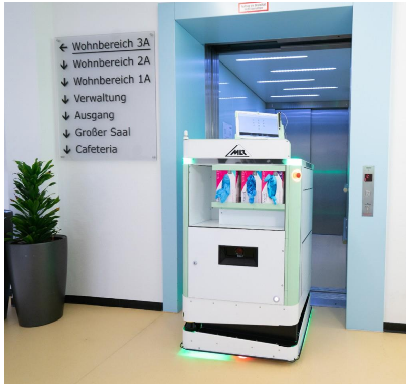
Εικόνα 23: Το ευφυές τρόλεϊ φροντίδας οδηγεί αυτόνομα στον προορισμό του (Εικόνα: R. Bez © Fraunhofer IPA)
