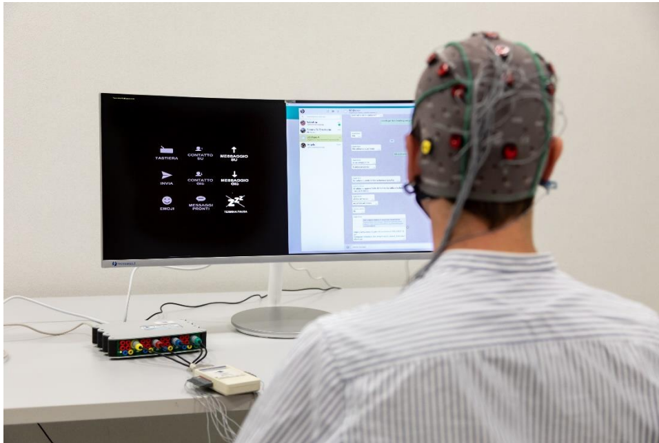
Εικόνα 75: Ένα παράδειγμα εγκατάστασης BCI που βασίζεται σε P300
