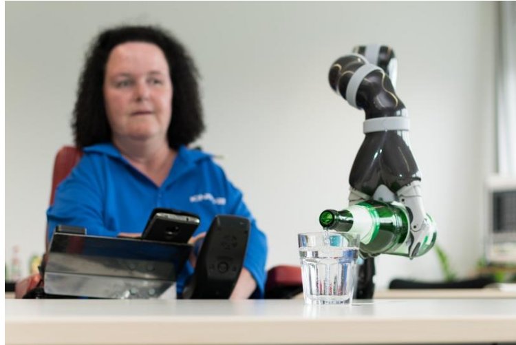
Εικόνα 28: Ρομποτικό μπράτσο βοηθάει τον χρήστη να χειριστεί ένα μπουκάλι νερού (Εικόνα: K. Rupp, Frankfurt UAS)
