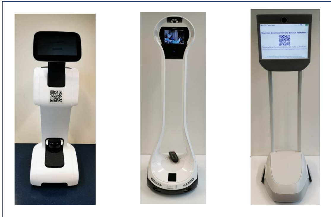
Εικόνα 24: Διαφορετικά συστήματα τηλεπαρουσίας: TEMI (Temi Global Ltd.), VGo (Vecna Technologies) and BEAM (Blue Ocean Robotics) (Εικόνες: K. Türkogullari, Frankfurt UAS)
