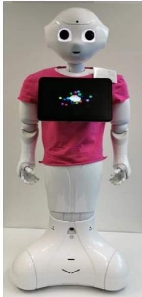
Εικόνα 27: Το διαδραστικό ρομπότ PEPPER (Softbanks) μπορεί να παίξει μουσική, να χορέψει και να αναγνωρίσει ανθρώπους. Στην οθόνη tablet του μπορούν να προστεθούν και άλλες λειτουργίες (Εικόνα : K. Türkogullari, Frankfurt UAS)
