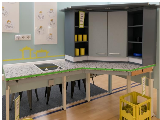
Εικόνα 8: Κουζίνα με επαρκή χώρο για αναπηρικό αμαξίδιο κάτω από την εστία. Έκθεση «Γεια σου Ελευθερία! Μαζί πέρα από τα εμπόδια» (Φωτογραφία: K. Rupp, Frankfurt UAS)
