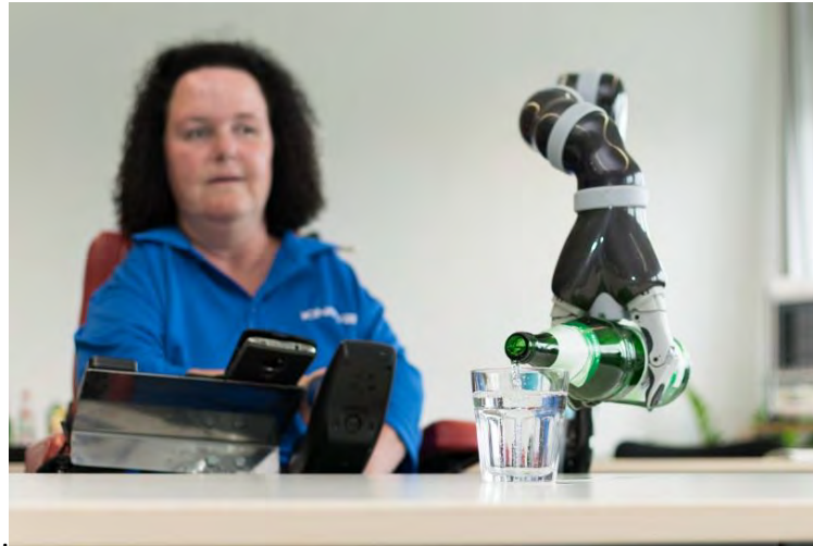
Abbildung 28: Roboterarm, der der Benutzerin bei der Handhabung einer Wasserflasche hilft (Bild: K. Rupp, Frankfurt UAS)
