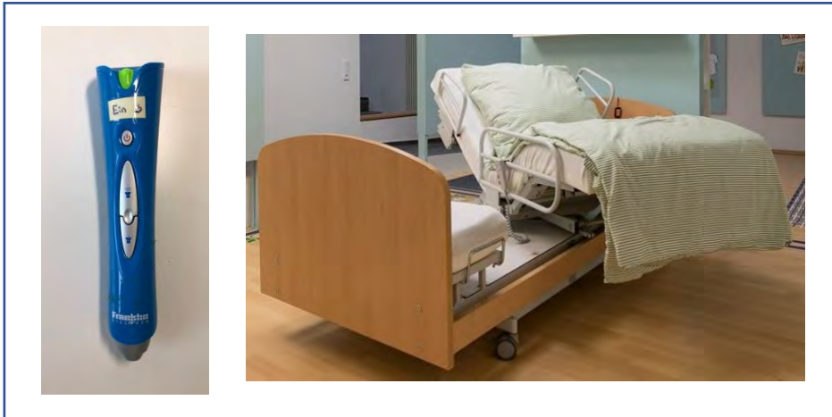
Abbildung 5: Mid-Tech AT: Stift, der auf einem Aufkleber gespeicherte Wörter vorliest (Bild: A. Dürr), elektronisches Bett, das Benutzenden beim Ein- und Aussteigen hilft (Bild: K. Rupp, Frankfurt UAS)
