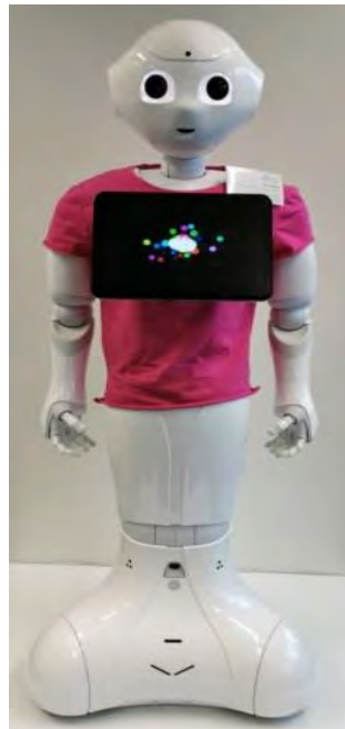
Abbildung 27: Der Interaktionsroboter PEPPER (Softbanks) kann Musik spielen, tanzen und Menschen erkennen. Auf dem Tablet-Monitor können zusätzliche Funktionen hinzugefügt werden (Bild: K. Türkogullari, Frankfurt UAS)
