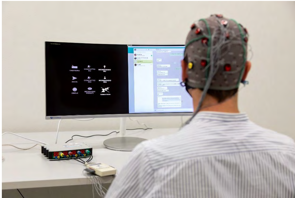
Abbildung 79: Ein Beispiel eines P300-basierten BCI Setup
