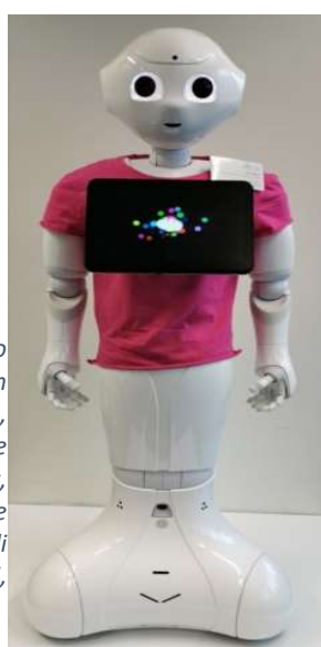
Figura 27: Il robot interattivo PEPPER (Softbanks) è in grado di suonare musica, danzare e riconoscere persone. Sul suo monitor, possono essere aggiunte funzioni addizionali (Immagine: K. Türkogullari, Frankfurt UAS).
