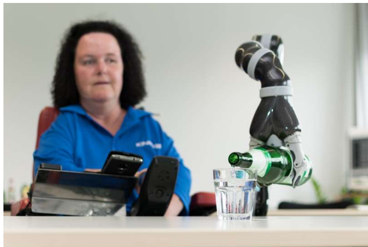
Figura 28: Un braccio robotico nell'atto di aiutare un utente a maneggiare una bottiglia d'acqua (Immagine: K. Rupp, Frankfurt UAS)
