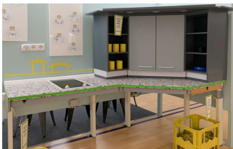
Figura 8: Cucina con spazio sufficiente per persone su sedia a rotelle sotto il piano cottura. Mostra “Hello Freedom! Insieme oltre le barriere”, Francoforte (Foto: K. Rupp, Frankfurt UAS)
