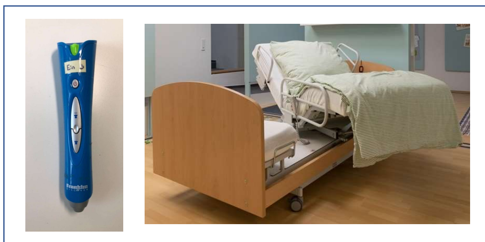
Figura 5: Mid-tech AT: penna che legge le parole salvate su un adesivo (foto: A. Dürr), letto elettronico che aiuta l'utente a salire e scendere dal letto (foto: K. Rupp, Frankfurt UAS)
