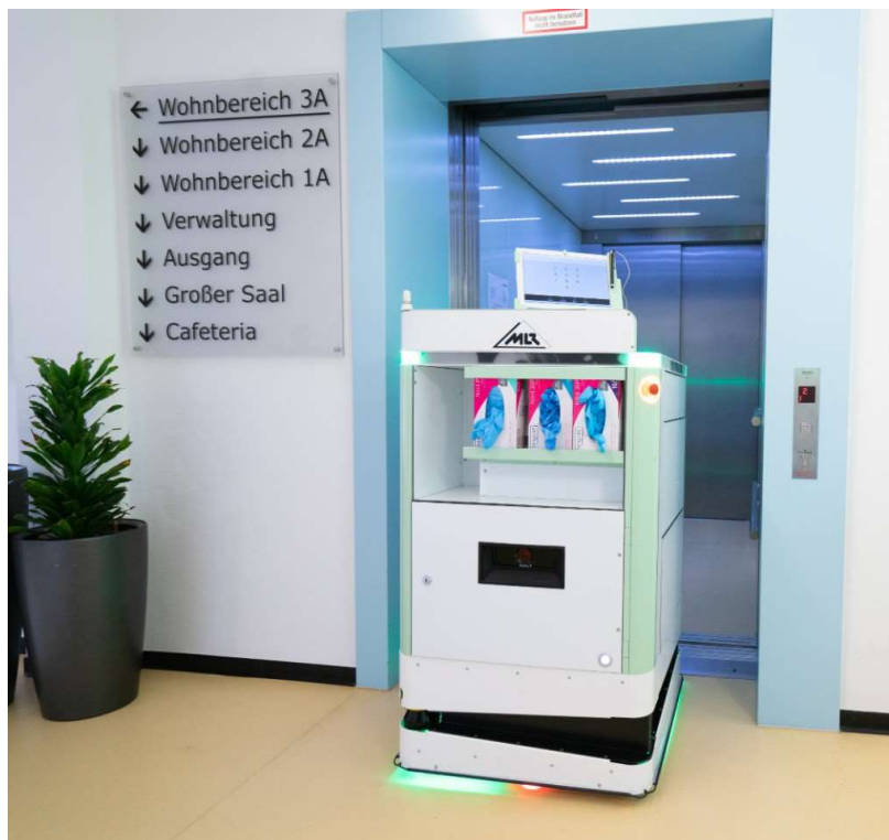
Figura 23: Il trolley di assistenza intelligente si muove autonomamente verso la propria destinazione
