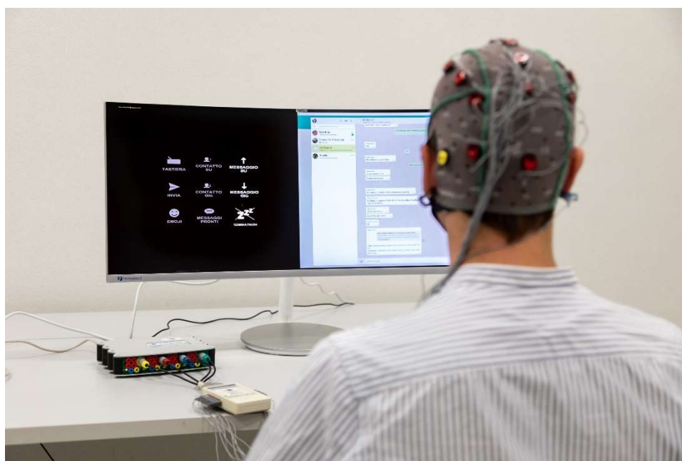
Figura 75: Un esempio di setup di una BCI basata su P300
